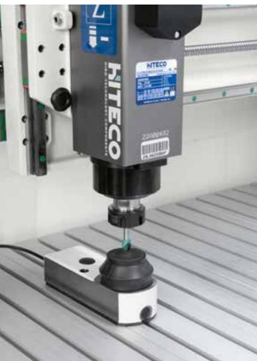
Sensor zur Erkennung der Werkzeughöhe
