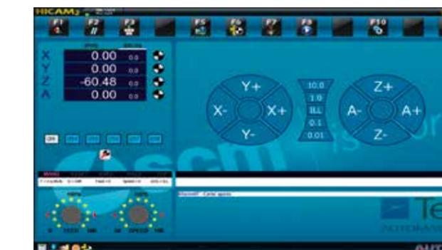
CNC-gesteuerte Bewegung mit 3 interpolierenden Achsen. Es können Werkzeuge mit einem Durchmesser von max. 60 mm und einer Werkzeugaufnahme von max. 16 mm verwendet werden.
