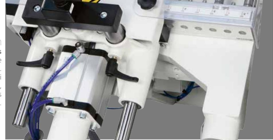
Die Maschine ist mit einem mechanischen Revolver mit 5 Bohrtiefe ausgerüstet.
