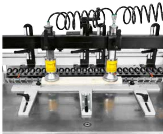
**Aggregate für Topfbandbohrungen**
