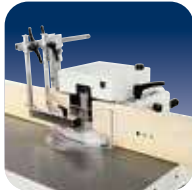
Fräsanschlag Schnelle Einstellung
