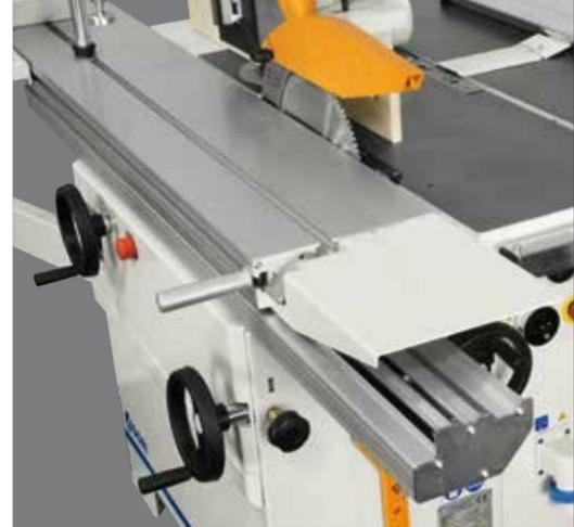
Präzisere und bequemere Schnitte mit der Säge, dank einer völlig stabilen Auflage, die – auch für große Werkstücke – durch den **Schiebeschlitten mit einer Breite von 270 mm** gewährleistet ist.
