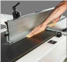
Klappbarer Zusatzanschlag Im Abrichtanschlag integriert, ermöglicht die Bearbeitung von kleinen Werkstücken unter bequemen und sicheren Arbeitsbedingungen.
