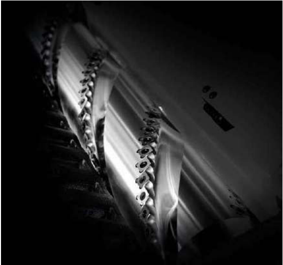
"Xylent" Spiralhobelwelle Die 3 Messerreihen gewährleisten eine ausgezeichnete Oberfläche. Die Xylent Spiralmesserwelle ermöglicht geräuscharmes Arbeiten und verbessert die Absaugung, da kleinere Späne erzeugt werden. Hohe Standzeit durch die Möglichkeit die Messer 4 mal zu drehen.
