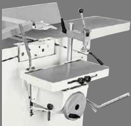
Guss-Longlochbohreereinrichtung Durch die Longlochbohreereinrichtung sind Nuten und Zapfen einfach ausföhrbar. Die Einrichtung ist komplett mit Absaughaube 120 mm Durchmesser und 16 mm Bohrfutter.
