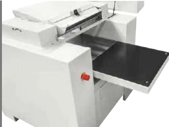
Dickentischverlängerung zur Verwendung beim Ein- oder Auslauf Kann am Ende des Arbeitstisches installiert werden.
